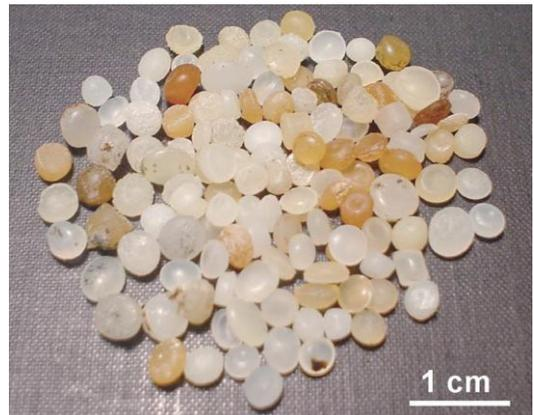
図 1 プラスチックペレット(高田、ぶんせき、2015、29-34 より)
